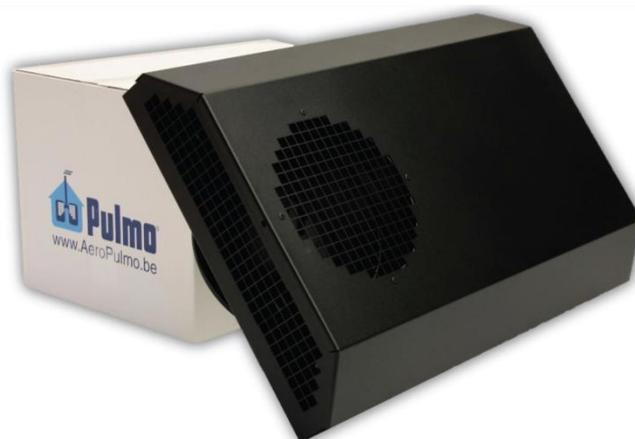
AspiroMural est une grille de passage murale regroupant le canal d'extraction et le canal d'expulsion. Cette grille simplifie l'installation de la tuyauterie d'extraction et d'expulsion vers l'extérieur. Les orifices d'extraction et d'expulsion sont placés de telle façon que l'air expulsé et l'air extrait ne se mélangent pas.
